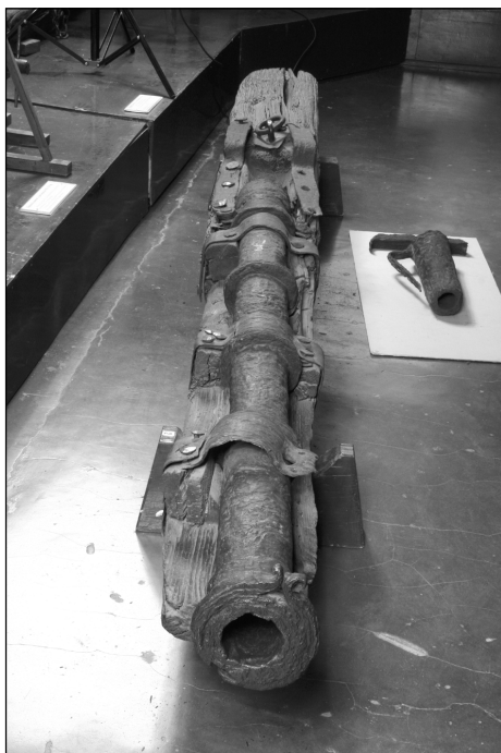
Рис. 6. Пушка железная казнозарядная конца XIV в. Экспонируется в зале «Истории артиллерии до середины XIX в.» Фото С.С. Рымши. 2007 г.
