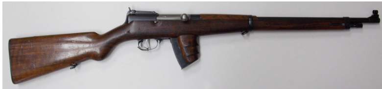
Ил. 1. Образец самозарядного карабина Токарева под патрон Нагана, 1928 г., № 3. Отличается от испытываемого в 1927 г. отсутствием автоогня, но дает представление о габаритах первых ППТ
