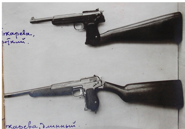
Ил. 7. ППТ – «короткий» и «длинный» с прикрепленными прикладами. У «длинного» приклад прикреплен оптимальным образом, без качки и расшатывания узла соединения
