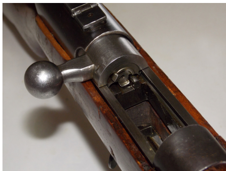
Ил. 13. Затвор на затворной задержке. Выступ на нижней части зеркала служит для зацепа за подаватель магазина
