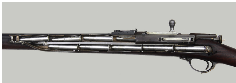
Ил. 2. Магазин модели 1884 г. емкостью девять патронов (вид изнутри)
