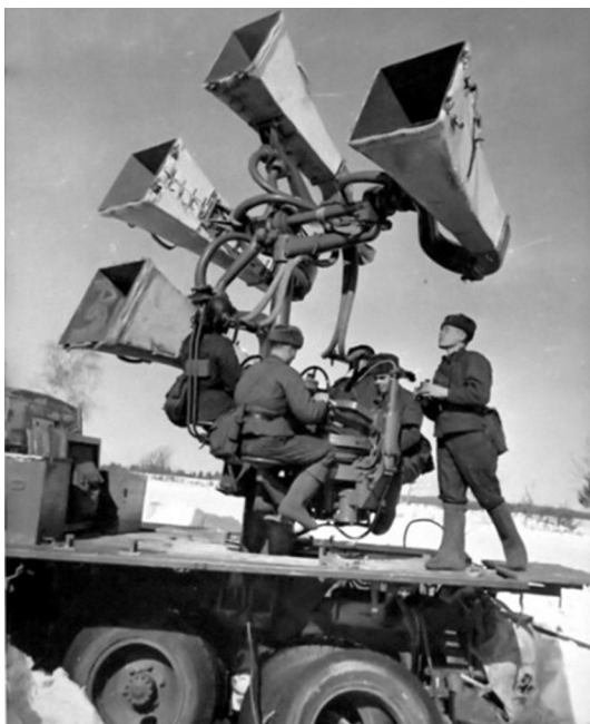
Ил. 10. Боевая работа расчета звукоулавливателя ЗТ-5 на ЗИС-6
