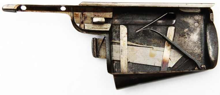
Ил. 6. Внутренний вид магазина емкостью четыре патрона; поджимная пружина включена
