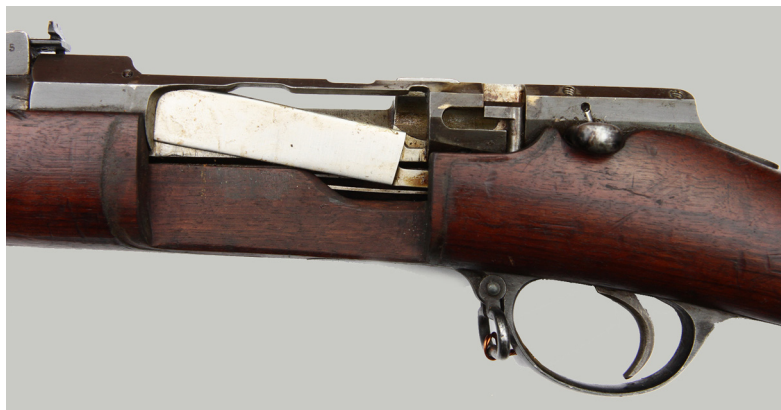
Ил. 7. Разобщитель включен, в таком состоянии установленный магазин будет неактивен
