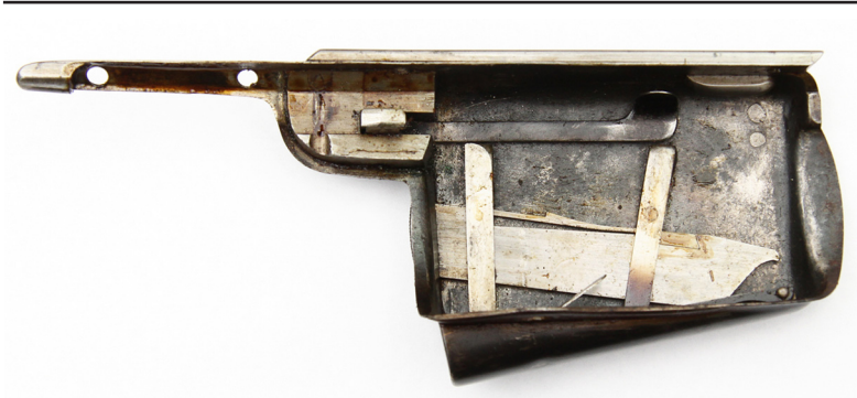
Ил. 5. Внутренний вид магазина емкостью четыре патрона; поджимная пружина в отключенном состоянии
