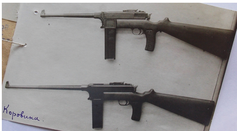
Ил. 10. Самозарядные карабины Коровина. Отличие только в длине ствола, что и нашло отражение в выводах комиссии (некоторое удивление)
