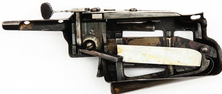
Ил. 11. Внутренний вид магазина емкостью восемь патронов; поджимная пружина в отключенном состоянии
