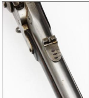
Рис. 4. Штуцер сист. Гартунга обр. 1848 г. капсюльный (ударный), переделочный, первый вариант. Прицел, щиток опущен. ВИМАИВиВС, № 100Ф 3/355
