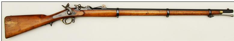
Ствол цилиндрический нарезной, скреплен с ложей хвостовым винтом и тремя стальными ложевыми кольцами; на кольцах выбиты неразборчивые клейма. На переднем ложевом кольце и перед спусковой скобой укреплены подвижные антабки для ремня. Прицельные приспособления состоят из гессенского прицела и мушки. Сверху на прицеле выбита буква М. Под стволом имеется стальной шомпол. Наконечник цевья латунный.
