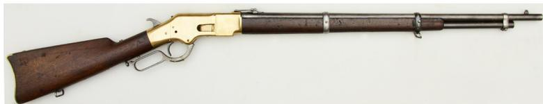
Ствол стальной цилиндрический нарезной, соединен с цевьем и магазином тремя стальными ложевыми кольцами. На среднем ложе-
