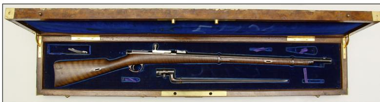
Ствол стальной цилиндрический нарезной. Прицельные приспособления состоят из мушки и рамочного прицела. Сверху на казенной части ствола выбита надпись: ИМПЕРАТОРСКИЙ ТУЛЬСКИЙ ОРУЖЕЙНЫЙ ЗАВ. 1883 г. Слева на основании прицела выбиты цифры 2 3 4 5. Сверху на рамке прицела нанесены цифры от 6 до 14.
