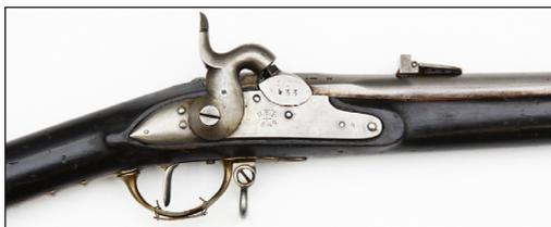
Рис. 2. Штуцер сист. Гартунга обр. 1848 г. капсюльный (ударный), переделочный, первый вариант. Средняя часть. ВИМАИВиВС, № 100Ф 3/355
