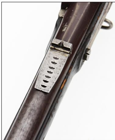
**Рис. 6. Штуцер сист. Гартунга обр. 1848 г. капсюльный (ударный), переделочный, первый вариант. Прицел с высоким щитком. ВИМАИВиВС, № 100Ф 3/352**
