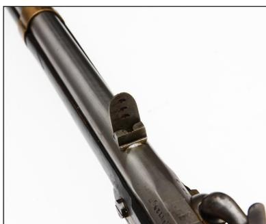
Рис. 5. Штуцер сист. Гартунга обр. 1848 г. капсюльный (ударный), переделочный, первый вариант. Прицел, щиток поднят. ВИМАИВиВС, № 100Ф 3/355
