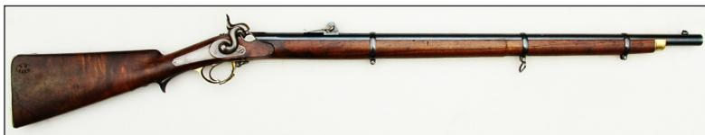
Ствол цилиндрический нарезной, с четырьмя нарезами, скреплен с деревянной ложей хвостовым винтом и тремя стальными ложевыми кольцами. Наконечник ложи латунный. Прицельные приспособления состоят из так называемого гессенского прицела и мушки. На среднем ложевом кольце и перед латунной спусковой скобой укреплены подвижные антабки для ремня.
