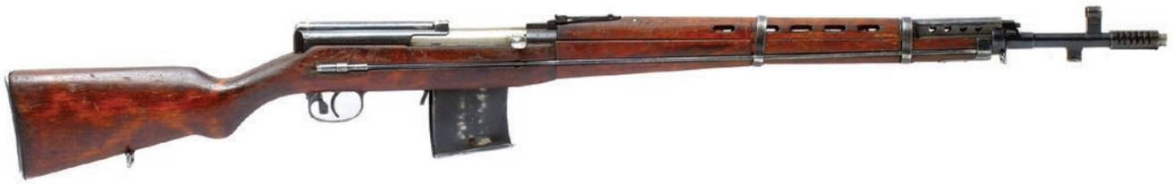
7,62-мм самозарядная винтовка обр. 1938 г. конструкции Токарева
