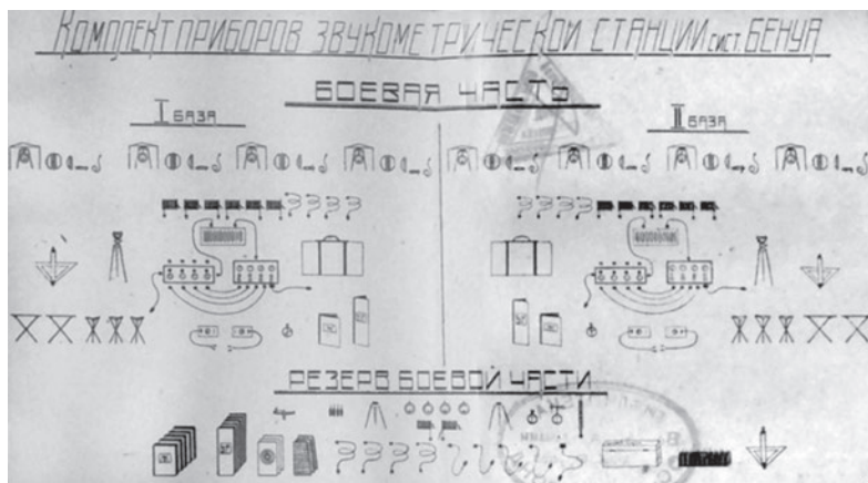
Ил. 5. Комплект приборов звукометрической станции системы Бенуа обр. 1927 г. ВИМАИВиВС
