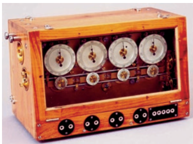
Ил. 2. Четырехциферблатный хроноскоп, изготовленный в Швейцарии фирмой «Фаварже и Ко» для ЗМС Бенуа образца 1915 г. ВИМАИВиВС
