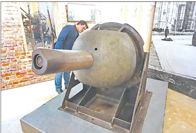
Такие казематные пушки предназначались для оборонительных укреплений, созданных в том числе внутри города. Шарообразная маска, закрывавшая орудие, вплотную, герметично, прилегал к амбразуре.
