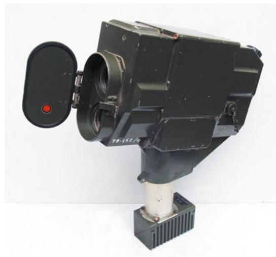
Устройство пусковое от 66-мм одноразового гранатомета М72А6 LAW для борьбы с легкобронированными целями. Место и время изготовления: США. 2010-е гг. ВИМАИВиВС 2ИОФ 074-86.
