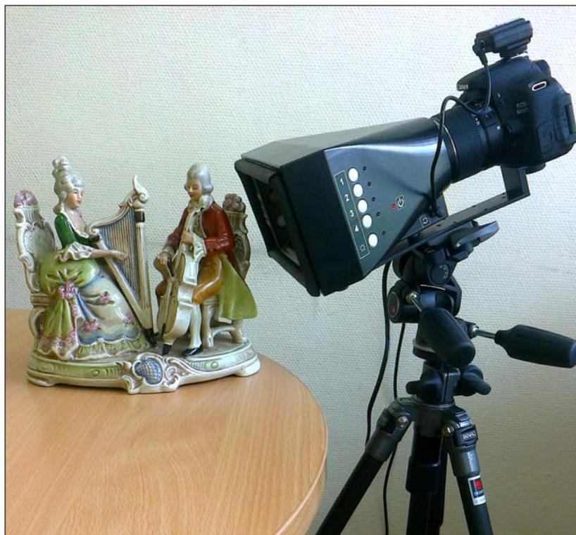
**Рис. 4. Прибор «Девис-18» для фоторегистрации идентификационных признаков маркировки**
