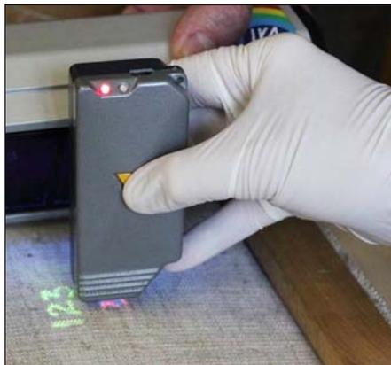
**Рис. 5. Устройство «Девис-17» для оперативного выявления и идентификации маркировки**
