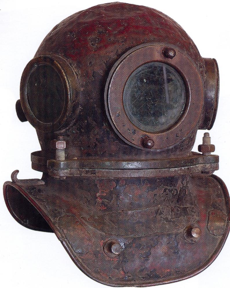
Шлем от трехболтового вентилируемого водолазного снаряжения обр. ЭПРОН 1930-х гг. 1941 г. (ЦВММ)
